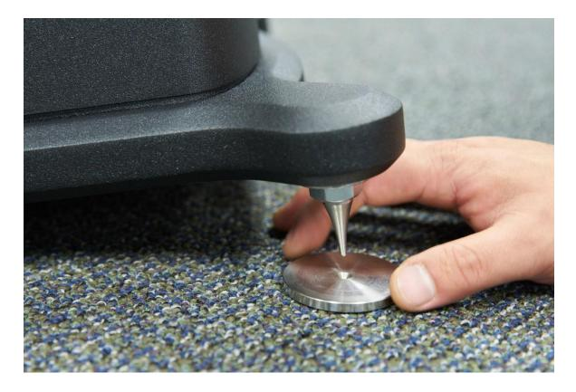
**16.** ADJUST THE SPIKES BY THREADING/UNTHREADING THEM TO LEVEL THE SPEAKER AND TIGHTEN THE LOCK NUT AGAINST THE PUCK TO LOCK THE SPIKE IN POSITION. REPEAT THIS PROCEDURE FOR ALL SPIKES.
